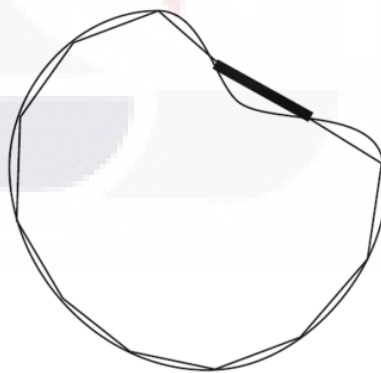
Figura 23 Líneas usadas para calcular concavidad [89]
