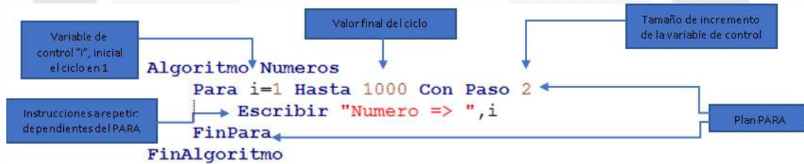
Ilustración 39: Ejemplo 1 plan condicional Para
