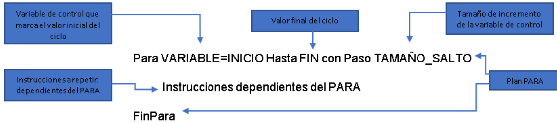
Ilustración 38: Plan de repetición PARA
