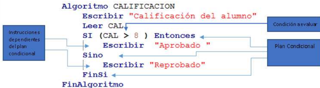
Ilustración 11: Ejemplo 2 condicional doble
