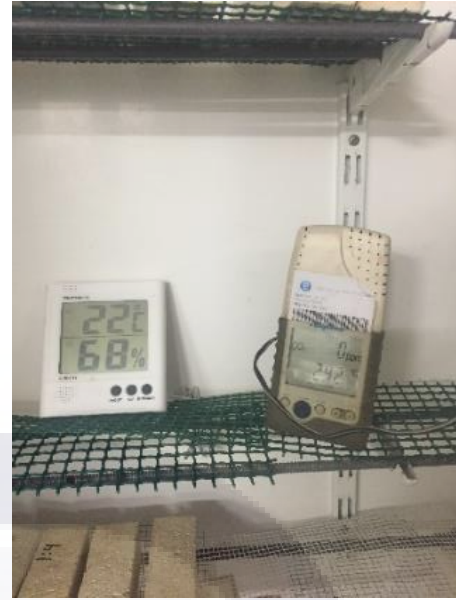
a) b) Ilustración 20. a) Probetas de mortero de cal más aditivos orgánicos, dentro de la cámara de carbonatación acelerada. b) Mecanismos de medición de CO 2 , temperatura y porcentaje de humedad. Fuente propia.
