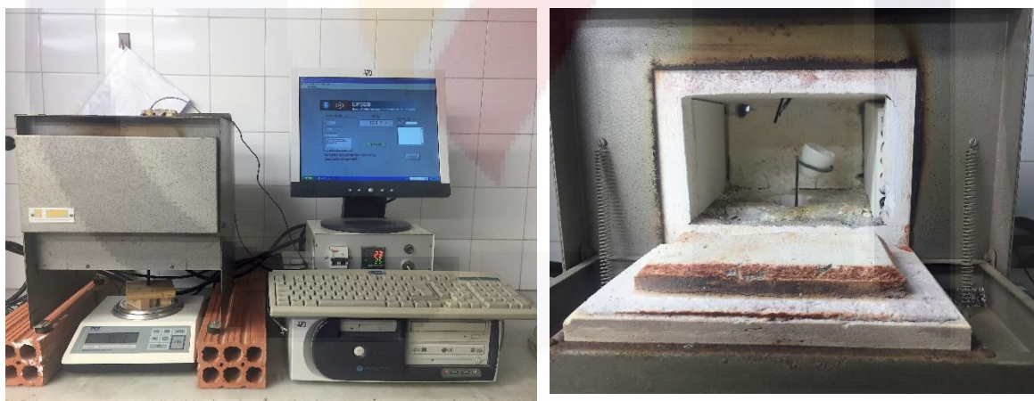
Ilustración 10. Sistema de equipos (equipo de TG, báscula de precisión, horno y computadora) para análisis termogravimétrico del laboratorio de materiales de EPSEB. Fuente: propia.
