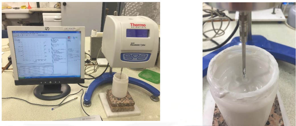
Ilustración 19. Mecanismos y dispositivos de software necesarios para la realización de la prueba de viscosidad. Fuente propia.
