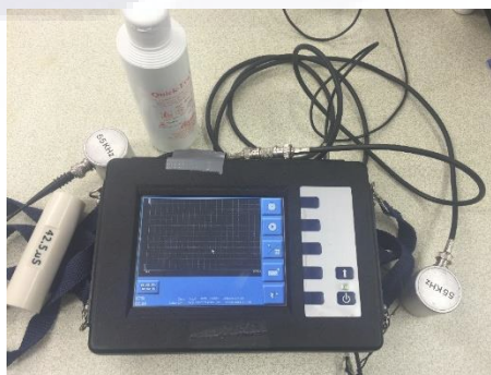
Ilustración 26. Equipo y receptores para medición de MOE por medio de ultrasonidos. Fuente propia
