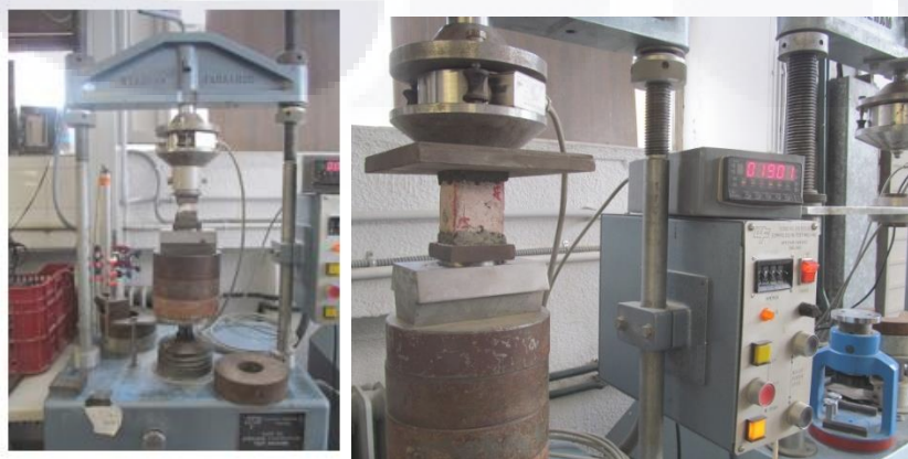
Ilustración 28. Probeta sometida a la resistencia a la compresión. Fuente propia.
