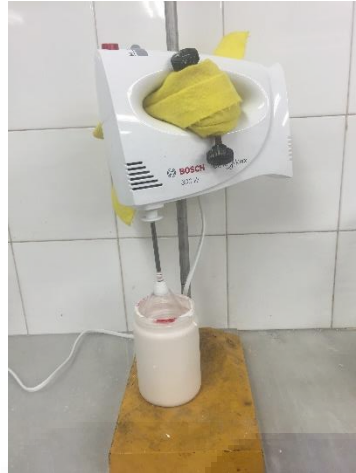
Ilustración 17. Agitador rotacional utilizado para el amasado previo al ensayo de pastas de cal más aditivos orgánicos. Fuente propia.
