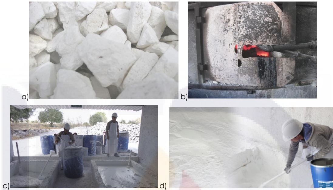
Ilustración 2. a) Piedra caliza, materia prima. b) Horno empleado para la calcinación de la piedra caliza y la obtención del óxido de calcio. c) Proceso de apagado del óxido de calcio para la obtención de Hidróxido de calcio, en este ejemplo para la obtención de cal en pasta. Fuente: Oxical.
