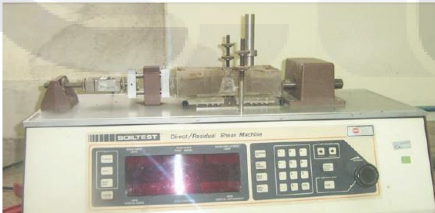
Figura 3.6. Aparato utilizado por Ávila (2004) para pruebas de deformación controlada.
