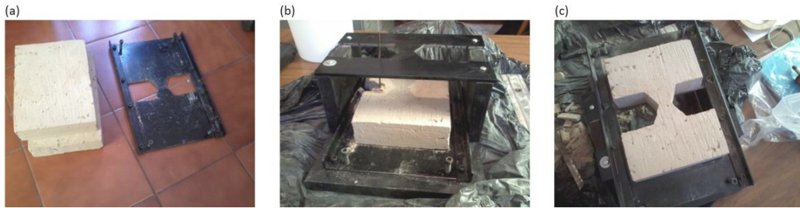
Figura 3.14. Proceso de labrado de muestras de suelo inalterado. (a) Bloques de suelo cortado con disco de diamante; (b) reducción de la sección transversal con una segueta; (c) muestra labrada.
