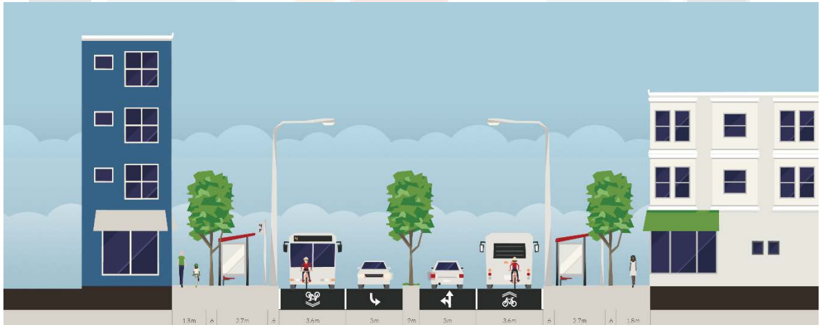
Imagen 52.- Sección propuesta para la Prolongación de la Av. Independencia de 25.5 m. Fuente: elaboración propia en base a los estándares internacionales.
