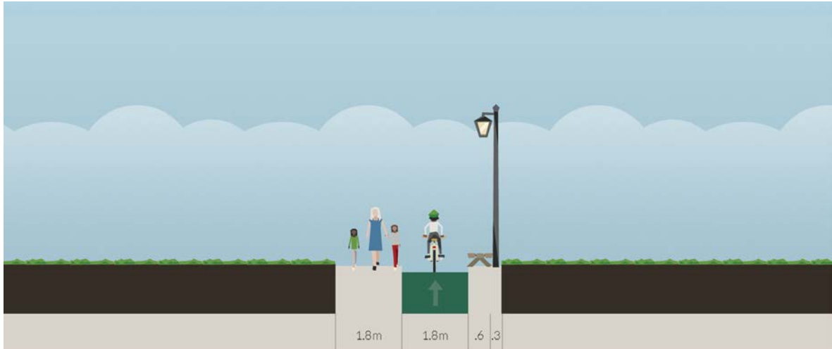
Imagen 57.- Sección propuesta para los senderos internos peatonales y para bicicletas de 4.50 m. Fuente: elaboración propia en base a los estándares internacionales.
