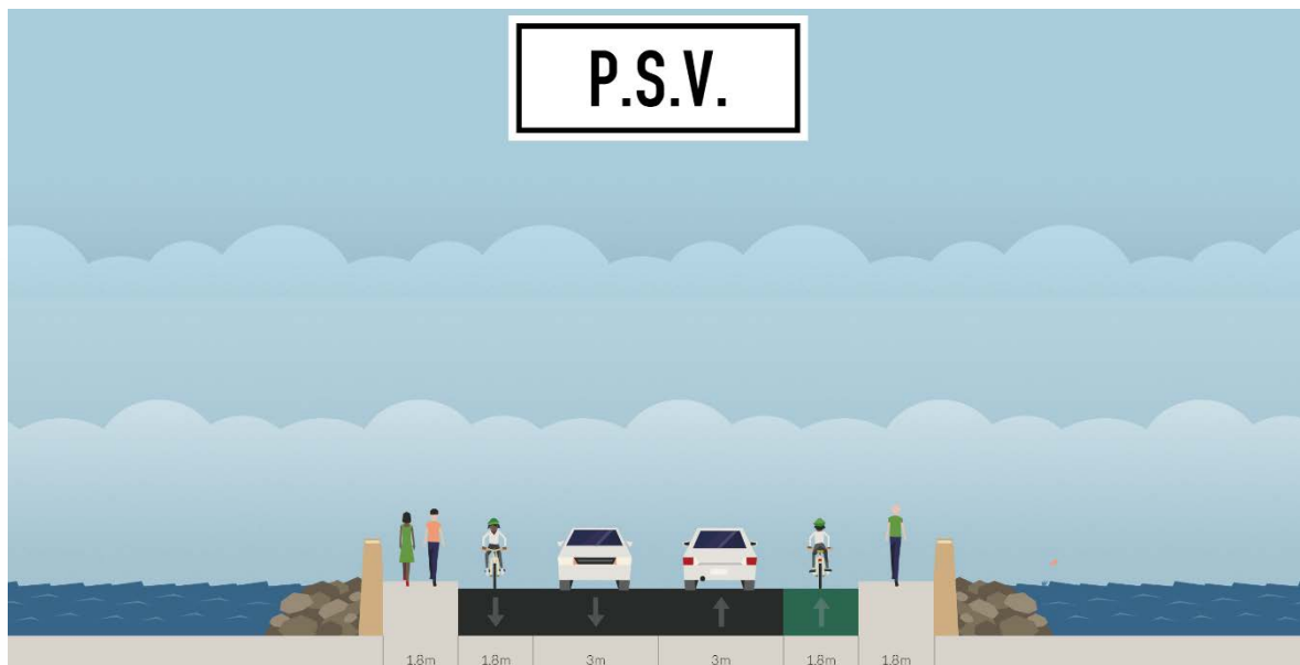
Imagen 55.- Sección propuesta para los Pasos Superiores Vehiculares (PSV) de 13.20 m. Fuente: elaboración propia en base a los estándares internacionales.
