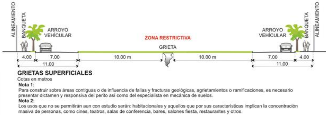
Figura 11. Restricción en grietas.
