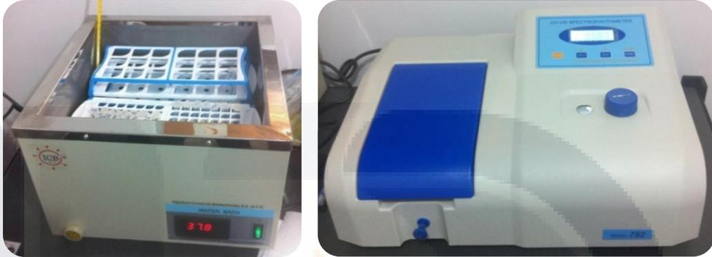
**Figura 15.** Izquierda: baño húmedo. Derecha: Espectrofotómetro utilizado para medición de la IgM (Fuente: elaboración propia).
