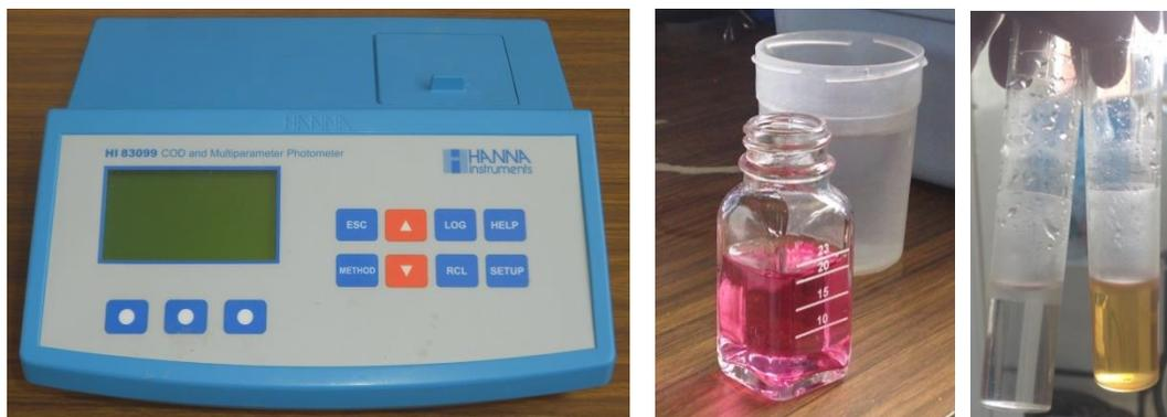
Figura 10. Izquierda: Equipo para evaluación de los parámetros fisicoquímicos de la calidad de agua. Centro: muestra para determinación de la dureza total. Derecha: muestra de amonio y el blanco correspondiente (Fuente: elaboración propia).
