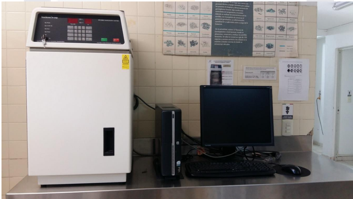
Figura 3.4 Aparato Faxitron X-Ray Corporation usado para el análisis de las semillas forestales .
