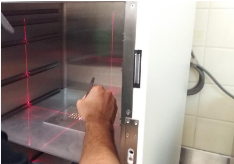
Figura 3.5 Colocación de semilla de referencia en el centro del aparato para la lectura.
