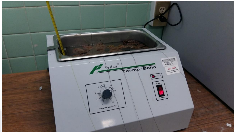
Figura 3.11 Escarificación de semillas de táscate con agua caliente en baño María.
