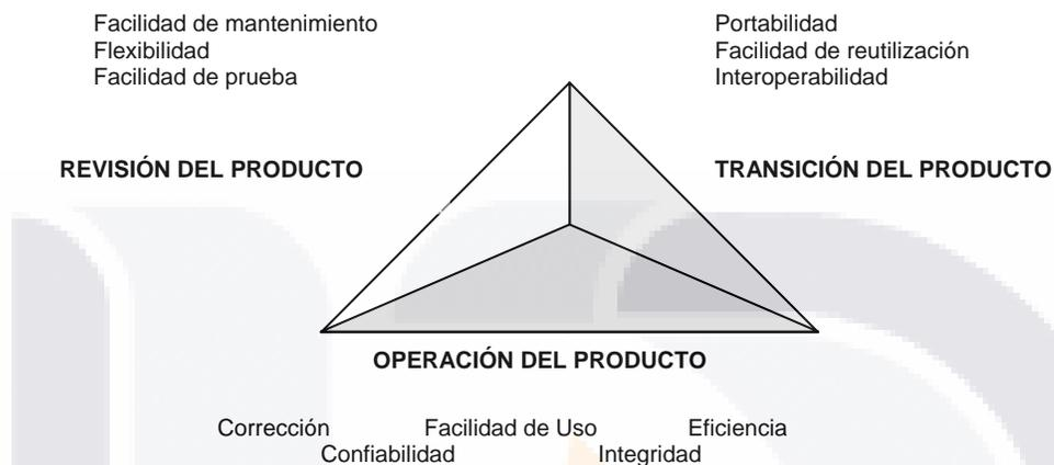
**Figura 2.** Factores de calidad del software de McCall (adaptado de Sommerville, 2002)
