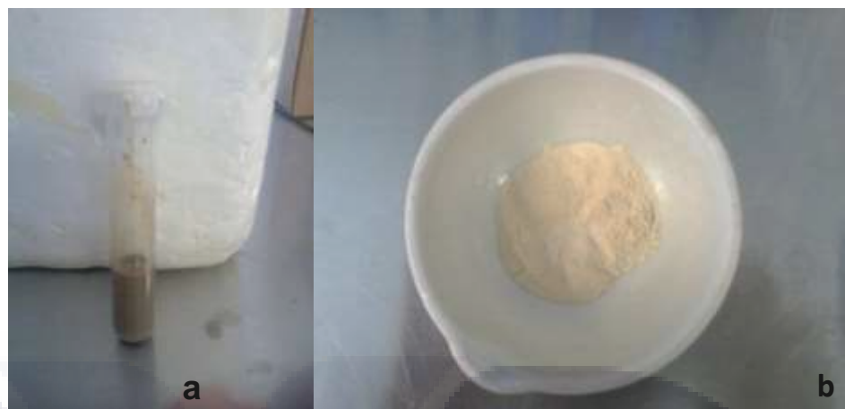
Figura 9 síntesis de \text{Fe}^{+3}\text{-TiO}_2\text{-xNx} por microondas a 150\text{ }^\circ\text{C} . a) solución sintetizada por microondas a 150\text{ }^\circ\text{C} . b) polvos obtenidos de la síntesis.
