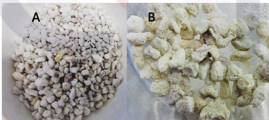
Figura 12. Perlitas utilizadas para soportar las NP's de \text{TiO}_2\text{-Cu}^{2+} (1%). A) Perlitas lavadas de color blanco sin NP's. B) Perlitas impregnadas con las NP's, de apariencia estable con cambio de coloración a verdoso.
