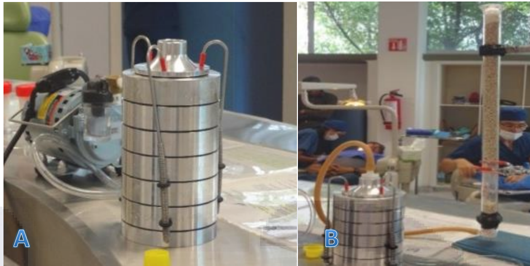
Figura 15. A. Impactador ambiental de Andersen para muestrear aire en interiores. B. Impactador ambiental conectado al prototipo de filtro de aire diseñado.
