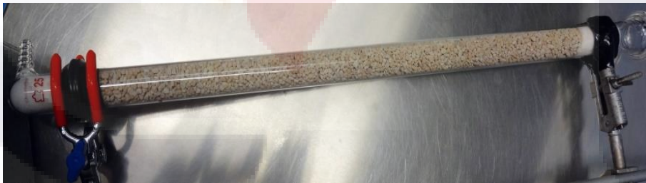
Figura 10. Prototipo diseñado del filtro de aire para el muestreo de aire de hospitales.
