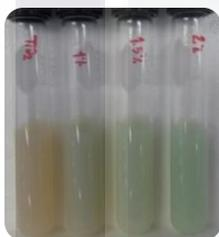
Figura 13. Síntesis sol-gel de  $\text{TiO}_2$ ,  $\text{TiO}_2\text{-Cu}^{+2}$  1, 1.5 y 2%.
