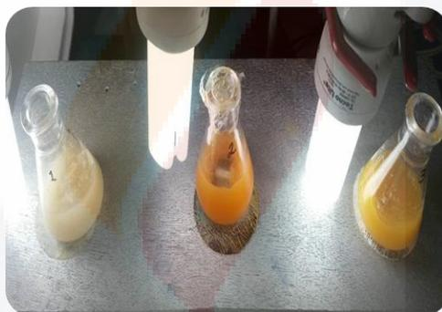
Figura 26. Fotocatálisis de naranja de metilo 20 ppm.
