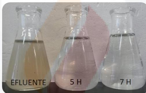
Figura 27. Muestras de agua del efluente antes y después del tratamiento con fotocatálisis.
