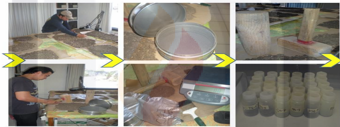
Figura 8. Secuencia desarrollada en laboratorio para la preparación de las muestras de suelo.
