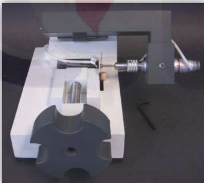
Figura 3. Vista frontal de la maquina realizada para el corte de las muestras.
