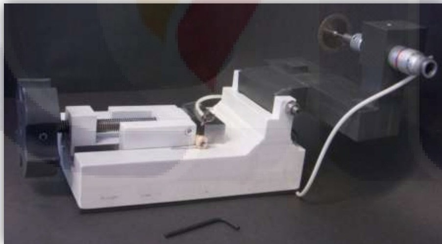
Figura 1. Vista lateral de la maquina realizada para el corte de las muestras.
