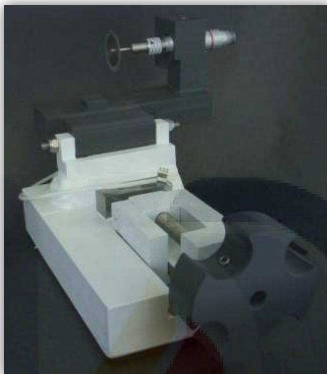
Figura 2. Maquina realizada para el corte de las muestras.
