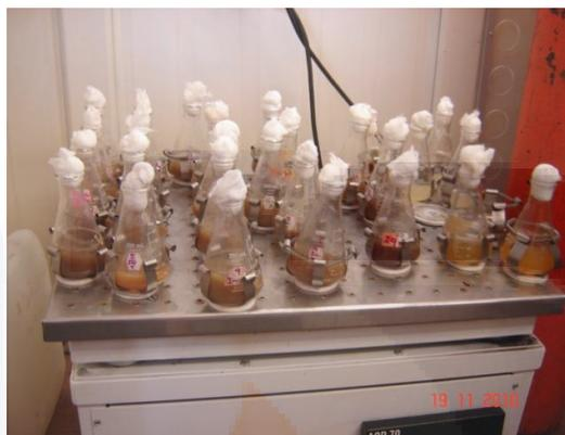
**Figura 19.** Biorremediación a vinaza tequilera tratada con alginato (VTA), dentro de la cámara controlada y en agitación orbital.
