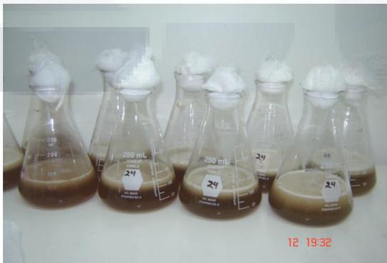
**Figura 10.** Matraces con medios de cultivo de acuerdo al diseño experimental  $2^3$ , inoculados para biorremediación de vinaza mezcalera tratada con alginato.
