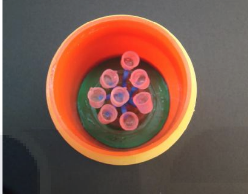
Fig. 39 Encajonado de los patrones con el cubilete.
