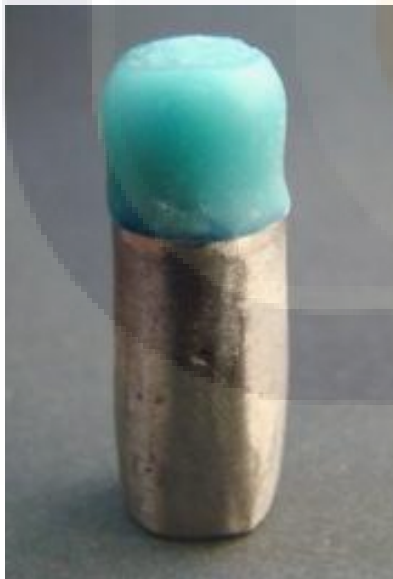
Fig. 17 Conformación del patrón de cera.
