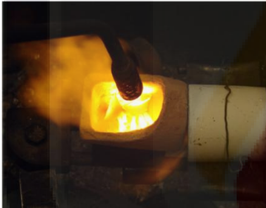
Fig. 47 Fundición del metal níquel-cromo.
