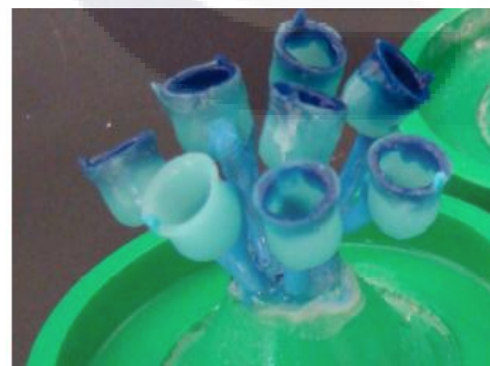
Fig. 37 Patrones de cera por sumersión colocados sobre la peana.
