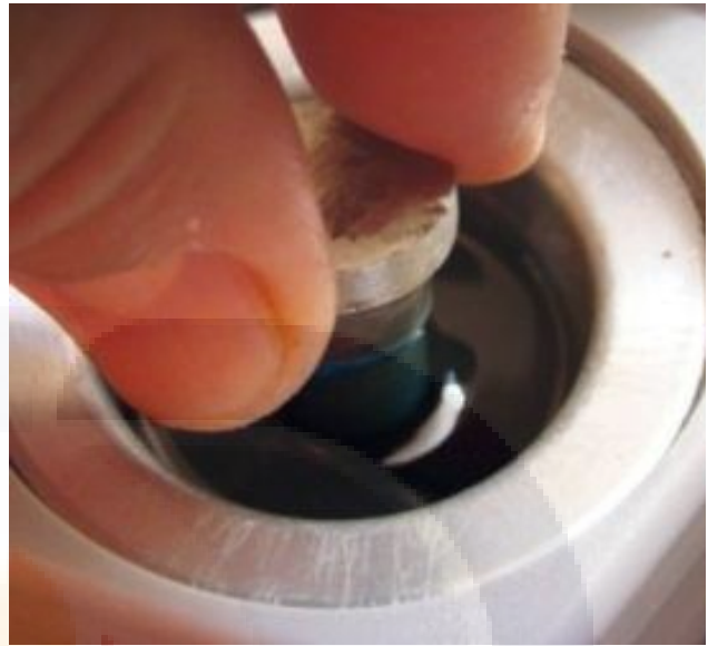
Fig. 16 Sumersión del dado maestro en cera líquida.
