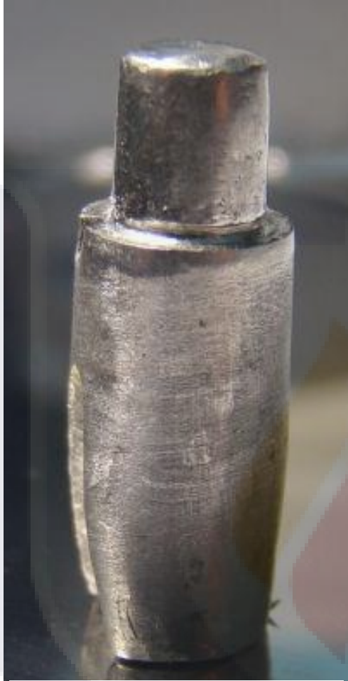
Fig. 9 Dado maestro en Níquel-cromo.
