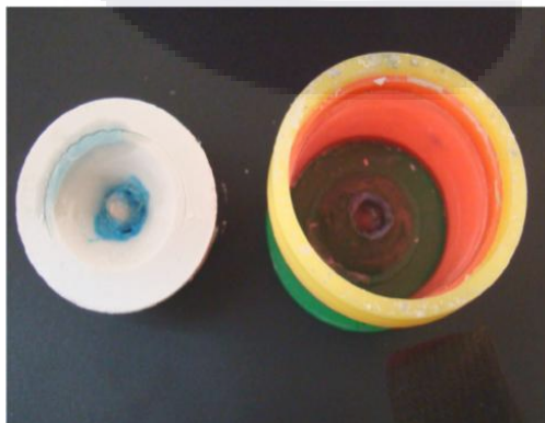
Fig. 43 Molde de revestimiento fraguado fuera del cubilete.
