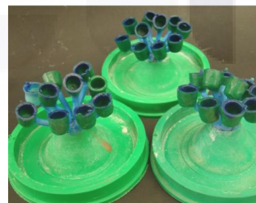
Fig. 38 Patrones de cera por técnica manual sobre las peanas.
