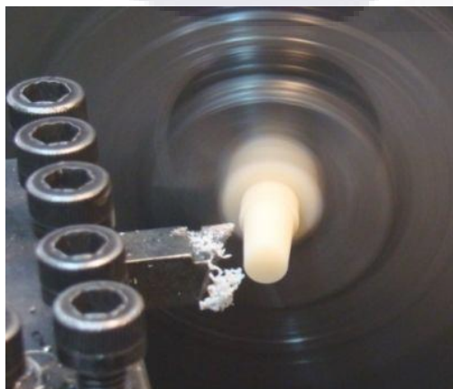
Fig. 5 cubo de acrílico siendo conformado en el torno paralelo.
