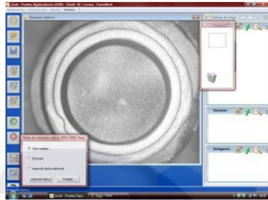
Fig. 20 Imagen del dado maestro capturada por el escáner InEOS.
