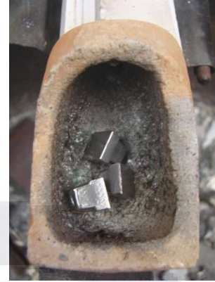
Fig. 46 Metal colocado en el crisol.
