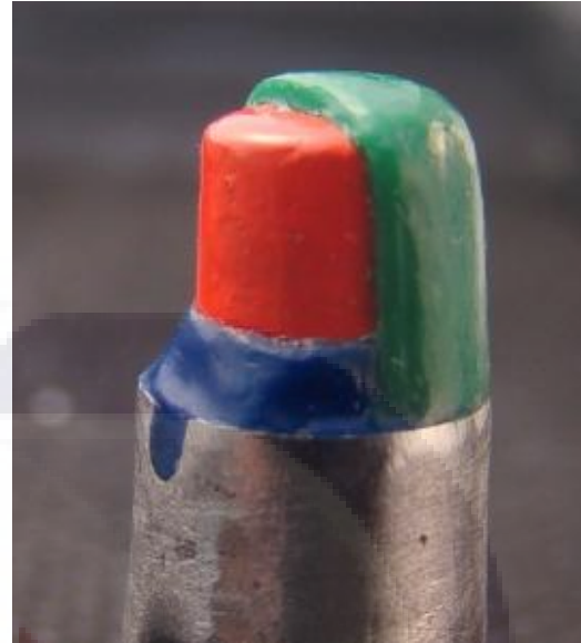
Fig. 12 Conformando el resto del patrón con cera fundida color verde.
