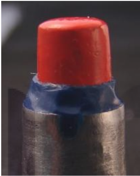
Fig. 15 Sellado del hombro con cera fundida.
