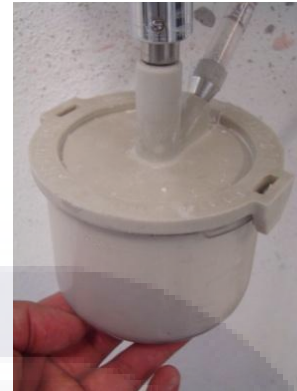
Fig. 40 Mezclado del revestimiento al vacío.
