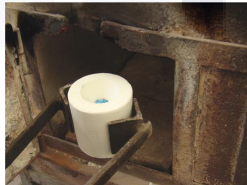
Fig. 44 Molde revestimiento siendo colocado en el horno.
