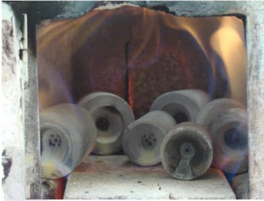
Fig. 45 Moldes de revestimiento dentro del horno.
