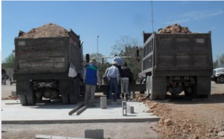
Figura 44 Muestra de los camiones para transferir carga por medio de una viga IR
