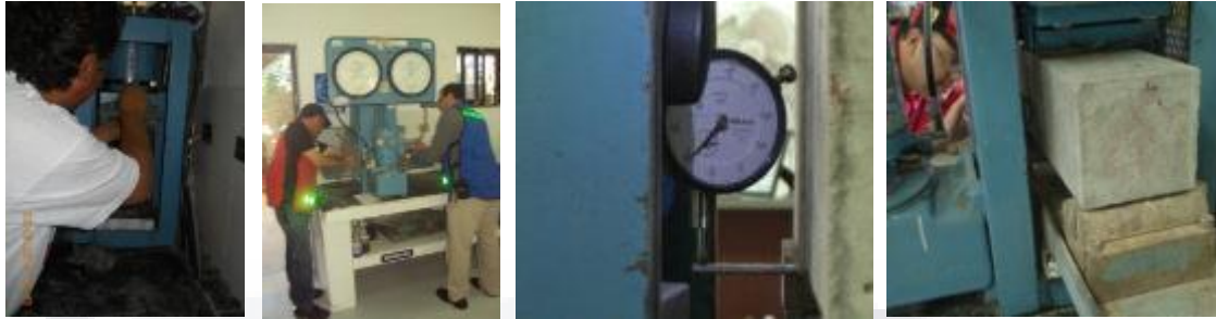
Figura 7 Secuencia de trabajos, colocación de riel de apoyo, adaptación de micrómetro y colocación de espécimen
