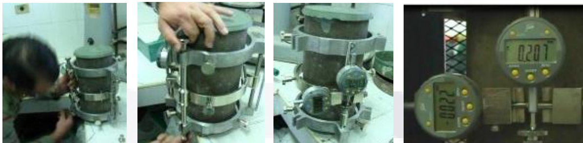
Figura 4 Colocación de dispositivo deformímetro extensómetro para determinar el módulo de elasticidad.
