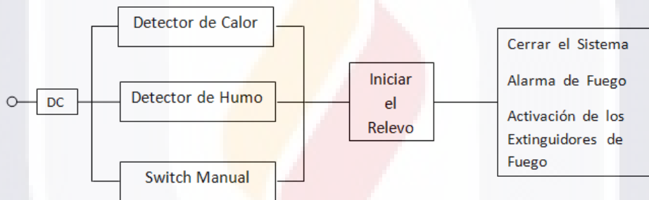
Figura 2.6: Esquema del Sistema Detector de Fuego
